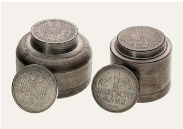
4 Prägewerkzeuge zur Herstellung falscher Markstücke 1954. Deutsche Bundesbank, NAC
